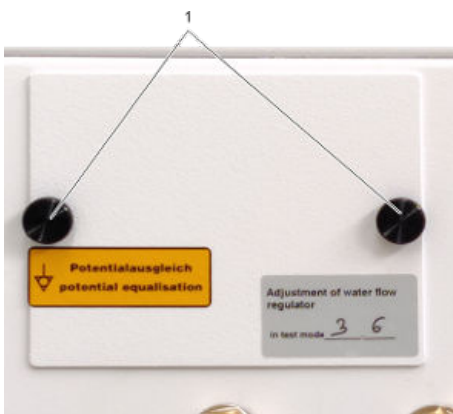
Fig. 133 : Retirer le couvercle
